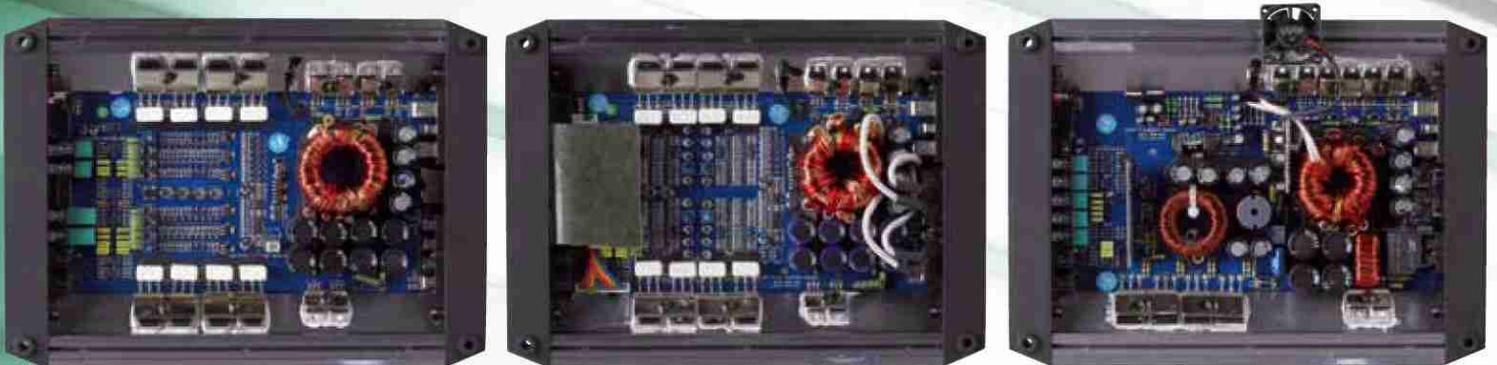
Zwei- und Vierkanalverstärker sind in Class-A/B-Technik aufgebaut, der Monoblock arbeitet als reiner Bassverstärker im Class-D-Prinzip
